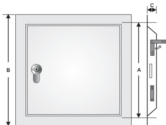
A = Foro muro (Foro Luce: A - 5 mm) B = Misura A+35 mm C = 25 mm
